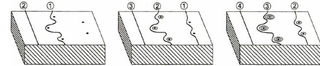
**Immobilisierende Versetzungen**, wie im Bild rechts gut erkennbar (Pin-Punkte), sind **Träger der Kaltverfestigung**. Sie führen zu einer Steigerung der kritischen Schubspannung gemäss  $\rho_{Vimm} = \frac{k}{D^2}$ , wobei k eine Konstante ist.
