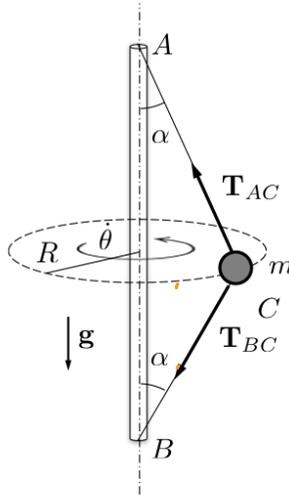
Was ist der minimale Wert von  $\dot{\theta}$ , so dass das Seil BC entspannt wird (das heißt  $|\mathbf{T}_{BC}| = 0$ )?
