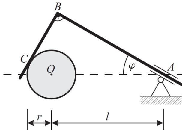
1. Zeichnen Sie in der gegebenen Lage die Richtungen der Geschwindigkeiten  $\mathbf{v}_A$  und  $\mathbf{v}_C$  der Stabpunkte  $A$  und  $C$  ein.
