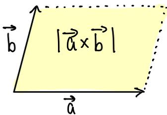
$|\vec{a} \times \vec{b}|$  ist die Fläche des Parallelogramms, welcher von  $\vec{a}$  und  $\vec{b}$  eingeschlossen wird.
