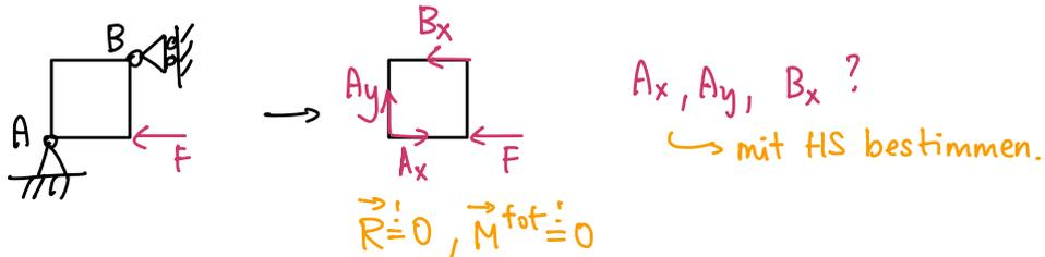
Bei Systemen mit mehreren Starrkörpern haben wir die Starrkörper getrennt, die internen Kräfte im Freischnitt eingezeichnet und den HS auf jeden einzelnen Starrkörper angewendet:
