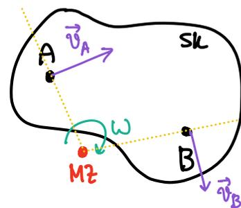
Translation:  $\vec{\omega} = 0 \Rightarrow \vec{v}_A = \vec{v}_B \quad \forall \text{ Punkte } \in \text{SK}$
