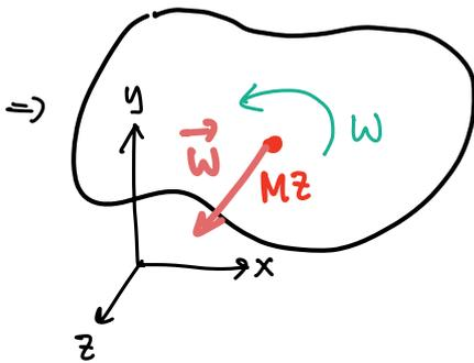
$\vec{\omega}$  ist nach der rechten-Hand-Regel mit  $\omega$  verknüpft. In diesem Bsp ist  $\vec{\omega} = \begin{pmatrix} 0 \\ 0 \\ \omega \end{pmatrix}$
