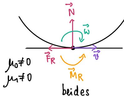
Bsp: Rotierende Welle an einer Wand:
