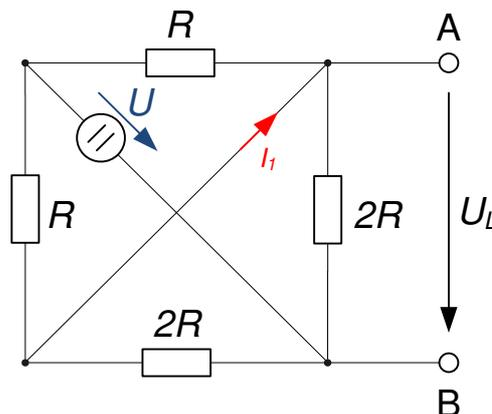
Fig.4: Netzwerk mit eingezeichneten Strömen
