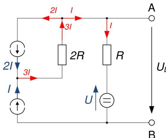
**Fig. 3:** Netzwerk mit eingezeichneten Strömen
