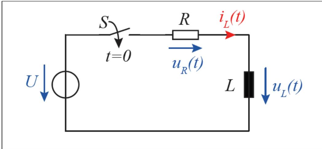
Der Schalter werde zum Zeitpunkt  $t = t_0$  geschlossen.
