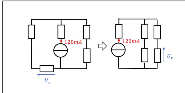
Nun berechnen wir den Strom  $I_{x_1}$  durch den Widerstand mithilfe eines Stromteilers:
