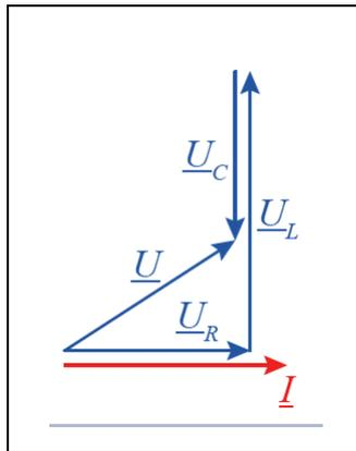
Für den Fall, dass wir  $\omega = \sqrt{\frac{1}{LC}}$  wählen, wird die Impedanz rein reell. Das Zeigerdiagramm sieht folgendermassen aus:
