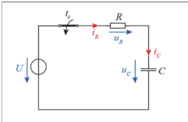
Der Schalter werde zum Zeitpunkt  $t = t_0$  geschlossen.
