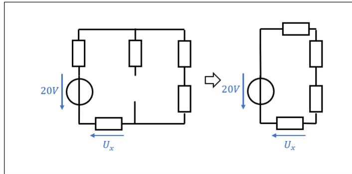
Die Spannung  $U_{x_2}$  berechnet sich als Spannungsteiler:
