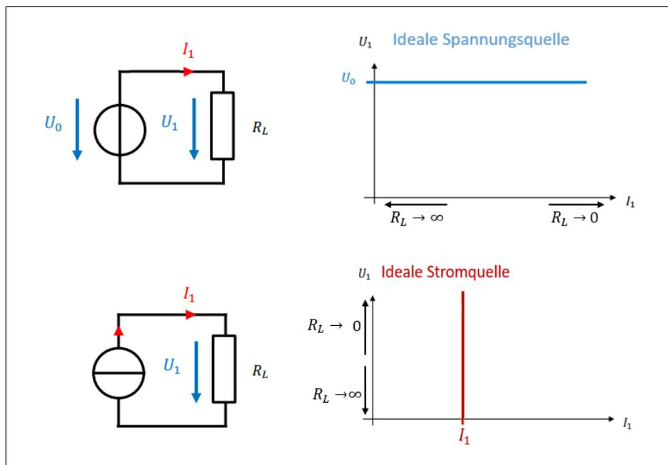
Mit idealen Strom-/Spannungsquellen können wir theoretisch unendlich viel Spannung/Strom über einem Lastwiderstand erzeugen.
