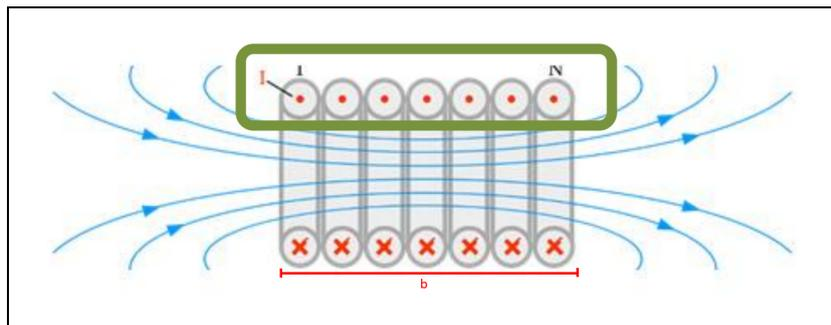
Im folgenden gehen wir davon aus, dass die magnetische Spannung ungefähr  $\Theta = \int_0^l \vec{H} d\vec{s}$  entspricht.
