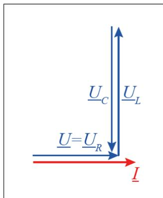
Innerhalb dieser Schaltung treten massive hohe Spannungen ( $U_L, U_C$ ) auf, welche von aussen **nicht messbar** sind und meist grösser als die Eingangsspannungen/Ströme sind.
