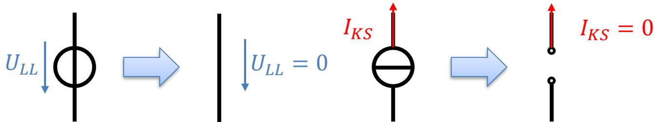
Spannungsquelle wird Kurzschluss
