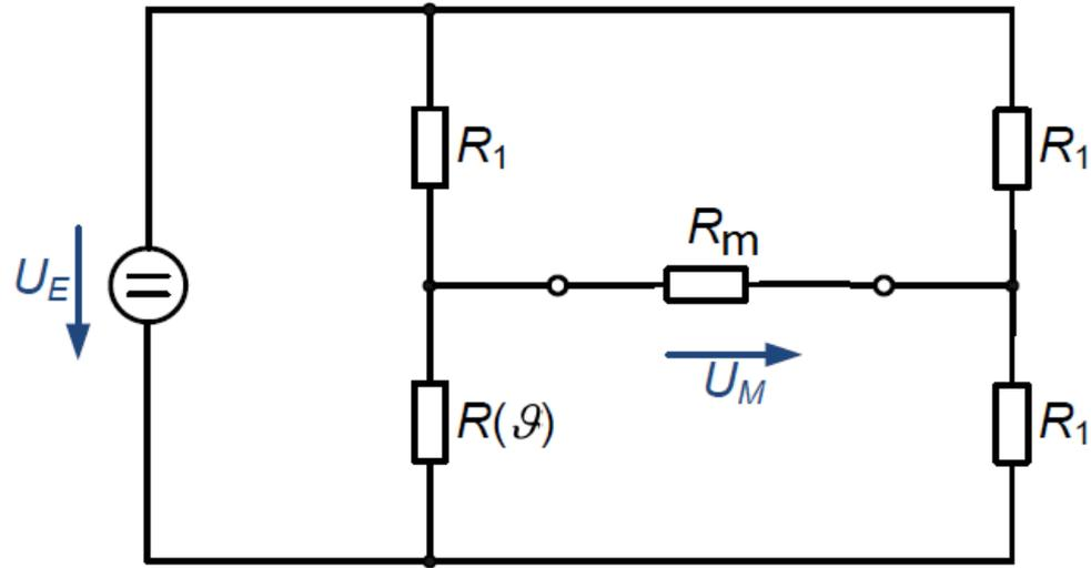
**Fig.2:** Brückenschaltung zur Temperaturmessung
