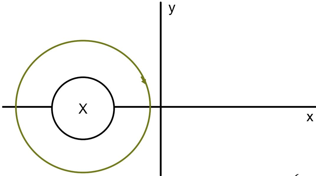
$$\vec{H}_1(x, y) = \begin{cases} -\frac{I}{2\pi} \cdot \frac{1}{R^2} \cdot \begin{pmatrix} -y \\ x+a \end{pmatrix}, & ((x+a)^2 + y^2)^{\frac{1}{2}} < R \\ -\frac{I}{2\pi((x+a)^2 + y^2)} \cdot \begin{pmatrix} -y \\ x+a \end{pmatrix}, & ((x+a)^2 + y^2)^{\frac{1}{2}} \geq R \end{cases}$$
