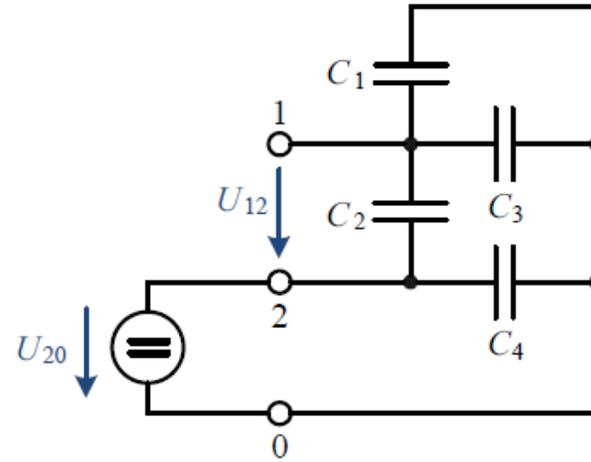
Figure 3.3: Netzwerk aus Kondensatoren mit Gleichspannungsquelle
